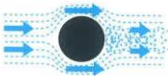
Slika 4: Odvajanje protoka zraka od cilindra [1]
