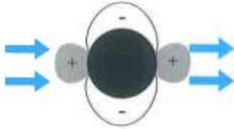
Slika 3: Tlak oko cilindra u idealnim uvjetima [1]
