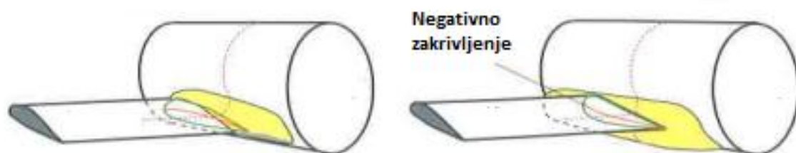
Slika 22: Konstrukcija za smanjivanje otpora interferencije pri pozitivno (lijevo) i pri negativno (desno) zakrivljenoj sekciji aeroprofila [1]
