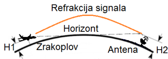
Slika 7. Utjecaj visine zrakoplova i refrakcija signala
