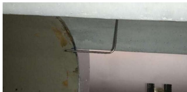
Slika 15. Položaj Pitot-Prandtlove cijevi u radnoj sekciji aerotunela
