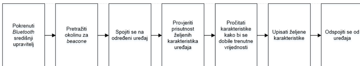
Slika 3.2. Prikaz redoslijeda zapisa informacija na Bluetooth odašiljač [30]
