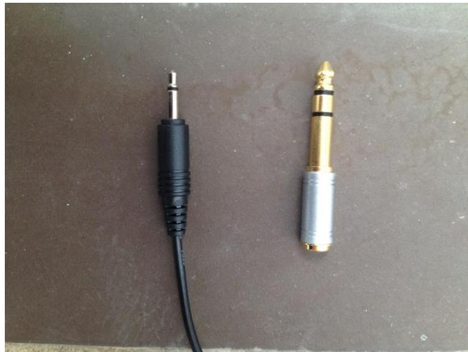
**Slika 2:** Izlazni kabl diktafona promjera 2 mm i utor promjera 2 mm s izlazom od 3,5 mm
