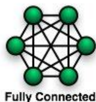
Slika 6. Isprepletana mrežna topologija [5]
