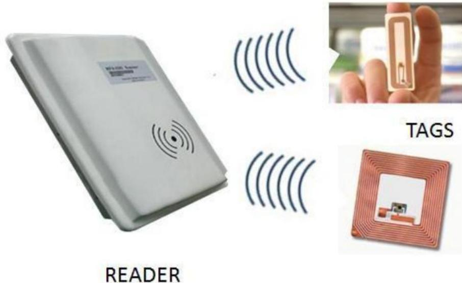
**Slika 13.** Funtcioniranje RFID-sustava [17]
