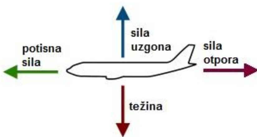
Slika 2. Djelovanje sile na zrakoplov tijekom ustaljenog horizontalnog leta [2]
