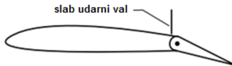
Slika 10. Utjecaj otklona zakrilca na udarni val u okozvučnom području [7]
