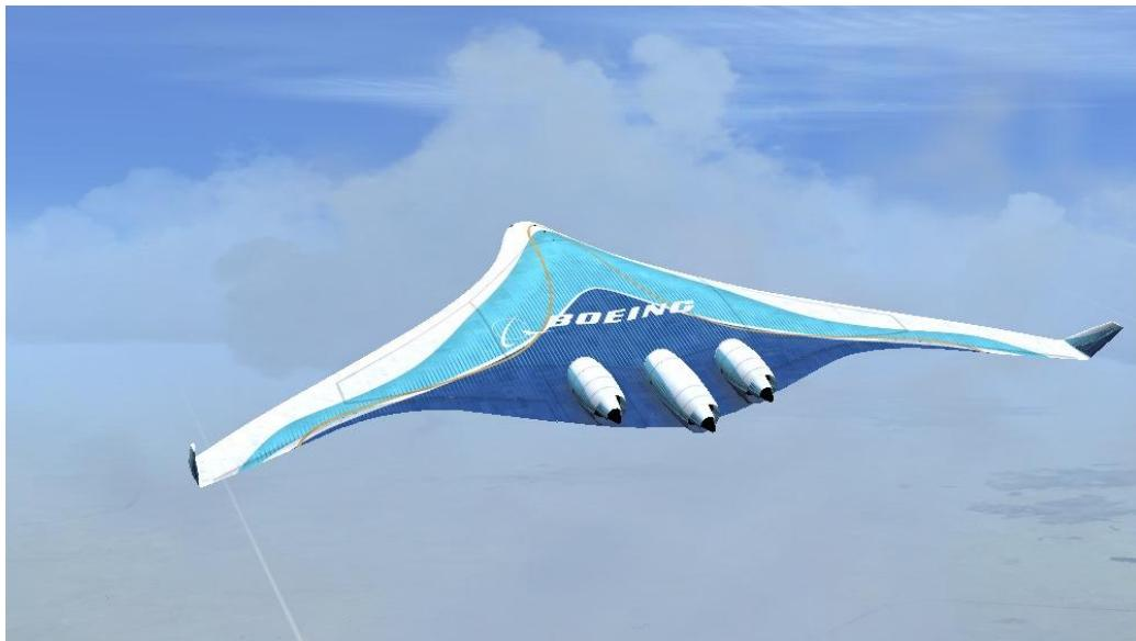
Slika 15. Primjer BWB koncepta na zrakoplovu Boeing 797 [21]
