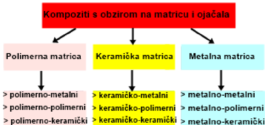
Slika 1. Podjela kompozita s obzirom na matricu i ojačala
