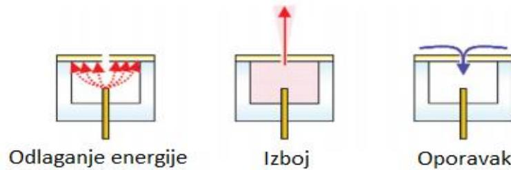
Slika 5: Konfiguracija elektroda kod LAFPA [10]
