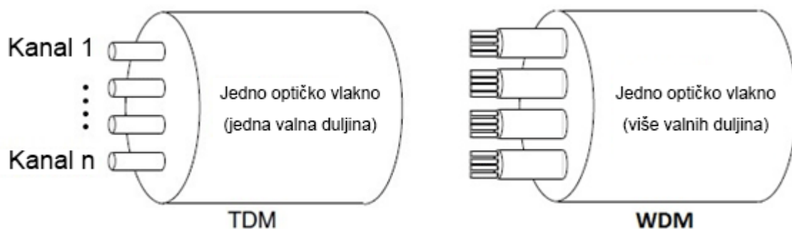
Slika 2.5. Usporedba iskorištenja kapaciteta za TDM i WDM, [3]
