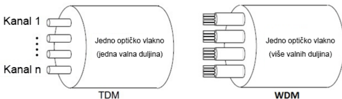
Slika 2.5. Usporedba iskorištenja kapaciteta za TDM i WDM, [3]
