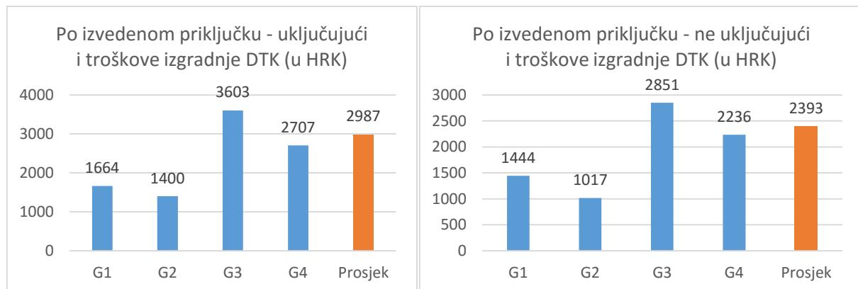
Graf 9. Kapitalni troškovi izgradnje FTTH mreže po izvedenom priključku uključujući i troškove izgradnje DTK [6]
