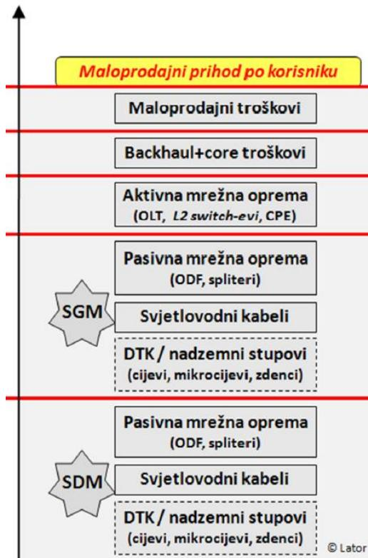
Slika 19. Struktura jediničnih troškova FTTH operatora [4]
