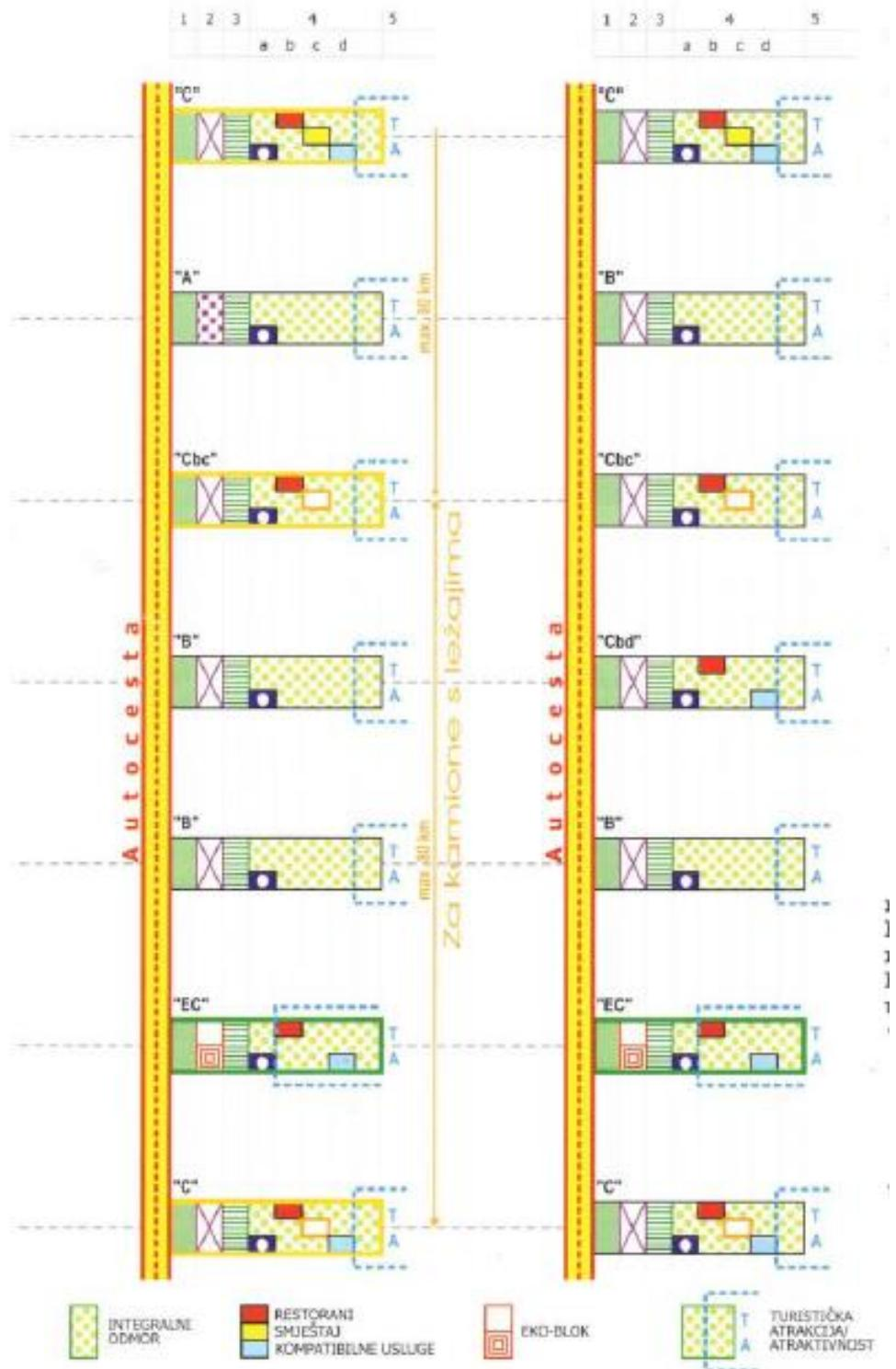
**Slika 29.** Shematski prikaz kompleksnog teorijskog funkcionalnog modela i faznog opremanja odmorišta uz autoceste s naplatom cestarine u Hrvatskoj
