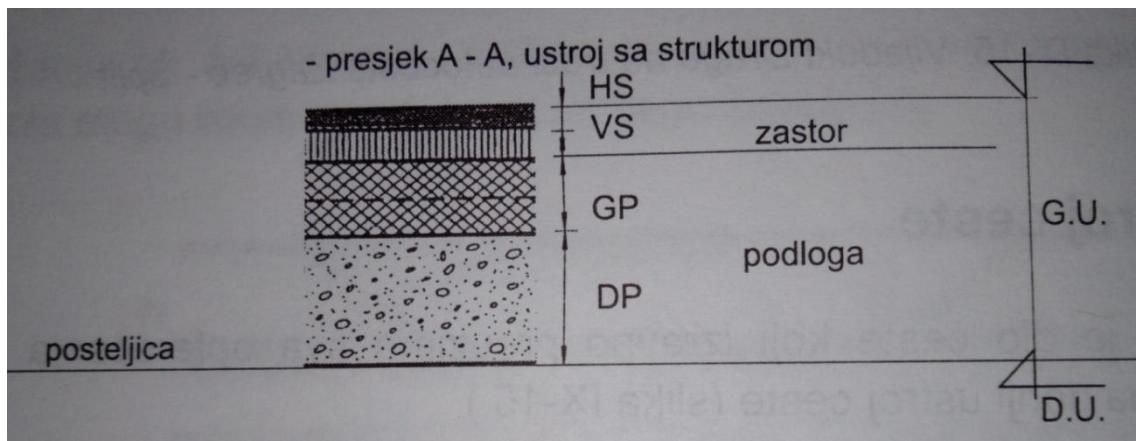
**Slika 6. Gornji ustroj s osnovnim slojevima kolnika**
