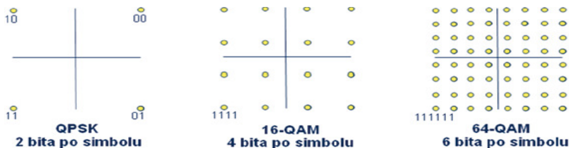
Slika 3.30. LTE podržane modulacije, [27]
