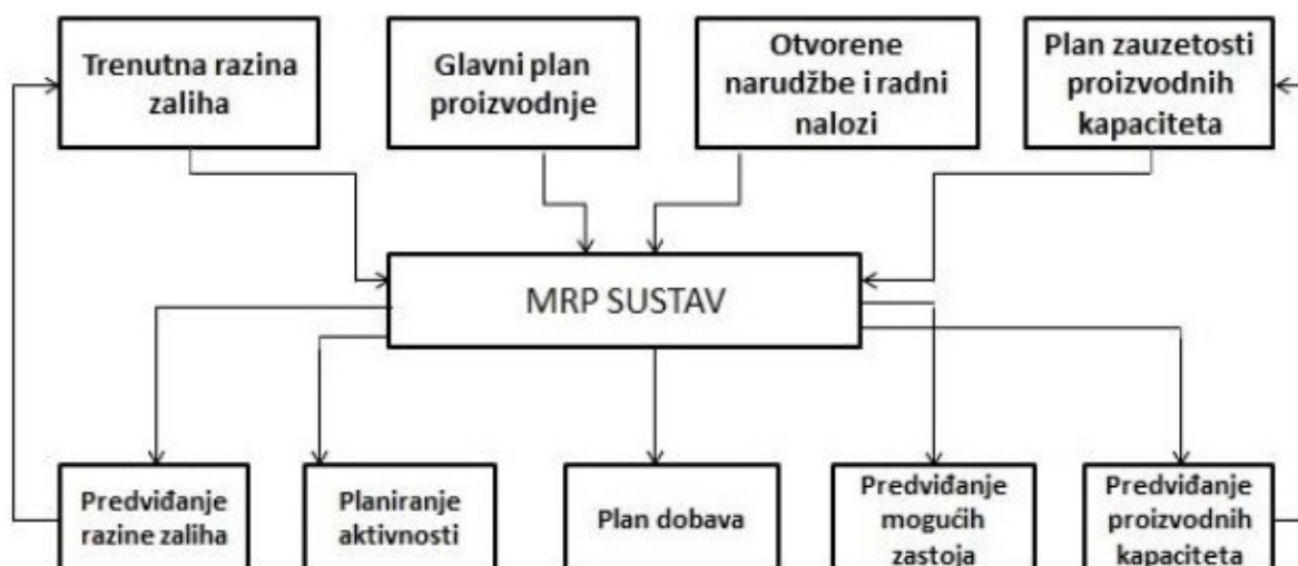
Slika 7. Prikaz sastavnih dijelova MRP sustava
