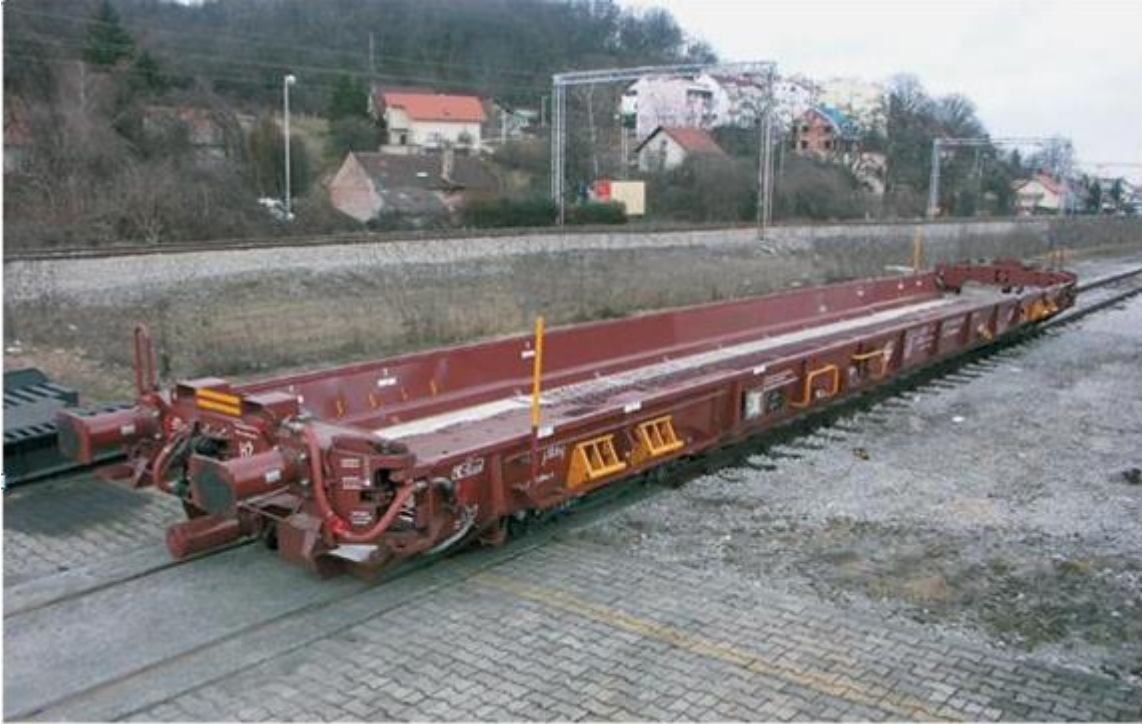
Slika 9. Specijalni vagon serije Saadkms
