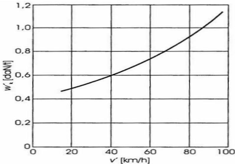
Slika 1. Ovisnost specifičnog otpora kotrljanja o brzini vožnje
