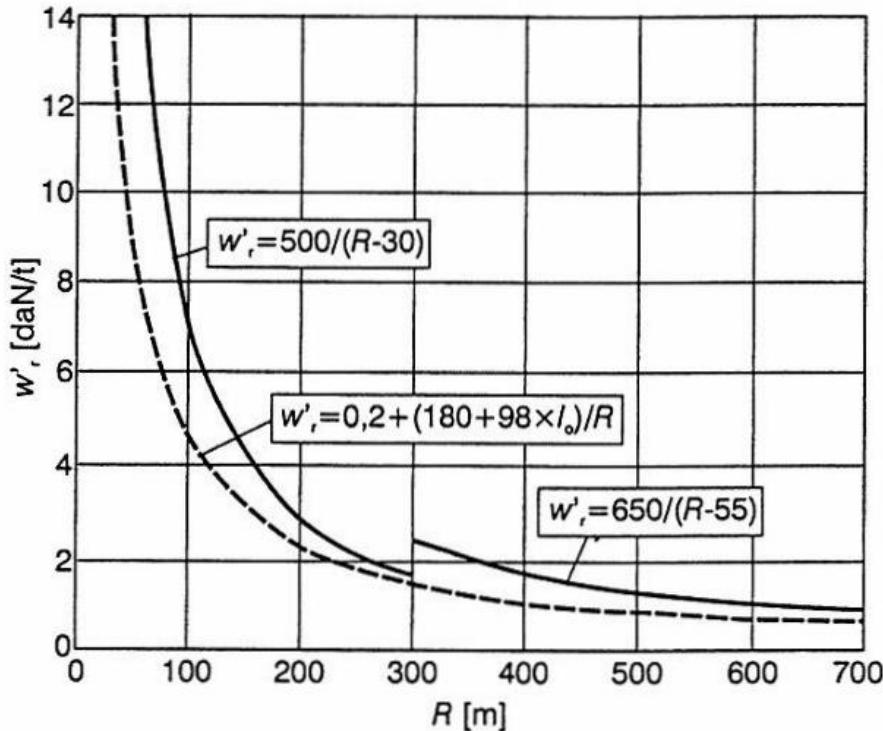
Slika 9. Ovisnost otpora u zavoju prema navedenim jednadžbama za  $L_o = 3\text{m}$
