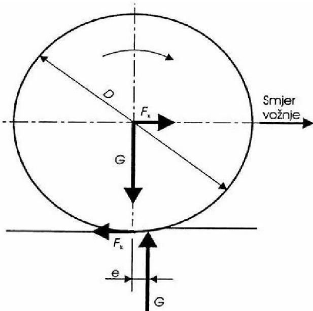
Slika 2. Shema sila na kotaču vučenom po tračnici
