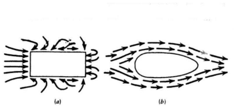
Slika 5. Otpor zraka ovisno o obliku vozila a) pravokutni oblik i b) oblik jajeta
