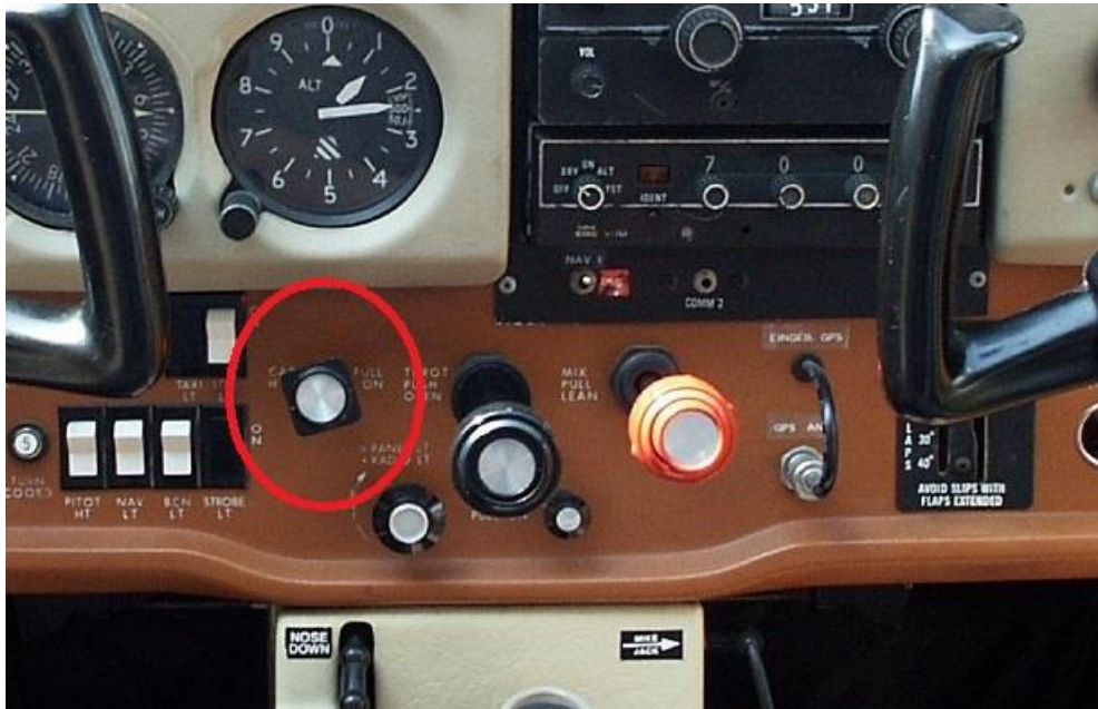
Slika 15: Ručica grijanja rasplinjača na zrakoplovu C172
