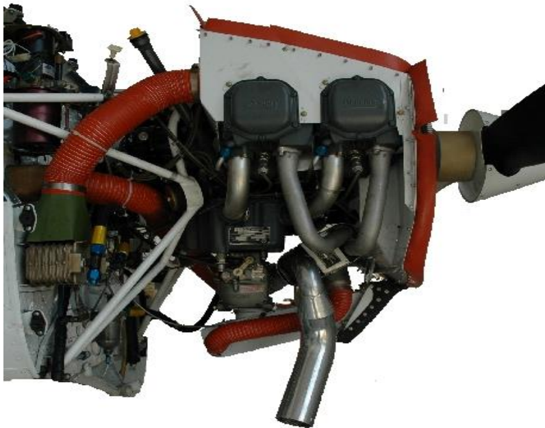
Slika 9: Ispušni sustav C172
