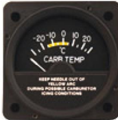
Slika 17: Instrument CAT na zrakoplovu C172
