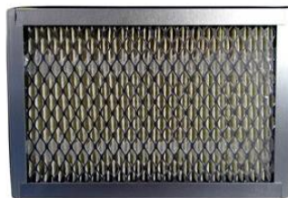
Slika 3: Pročistač zraka za C172
