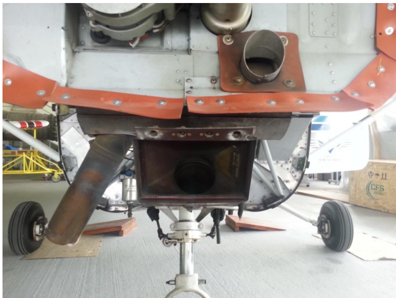
Slika 5: Pogled na dijelove usisnog i ispušnog sustava C172
