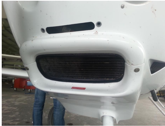
Slika 4: Pogled na pročistač usisnog sustava DV20
