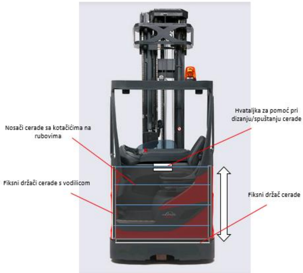
Slika 28: Djelomično zatvaranje otvorene strane visokoregalnog viličara po principu rolete Izvor: Izradio autor
