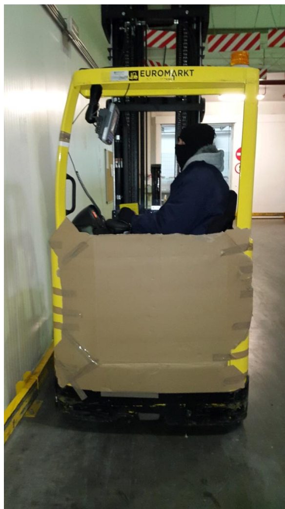
Slika 23: Improvizirana zaštita postavljena na visokoregalni viličar Izvor: Izradio autor
