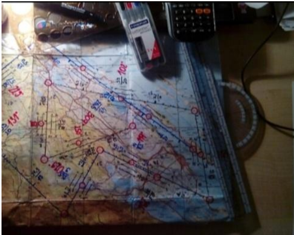
Slika 6. Izgled pripremljene navigacijske karte kao rezultata prethodne navigacijske pripreme
