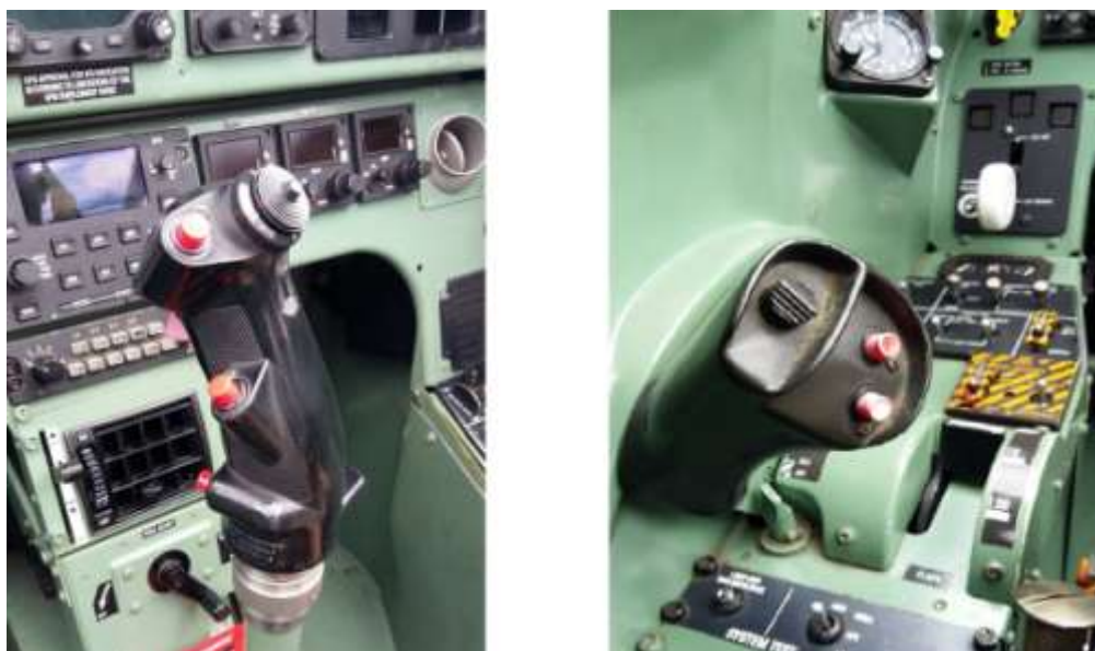
Slika7. Upravljačka palica i ručica snage HOTAS tipa
