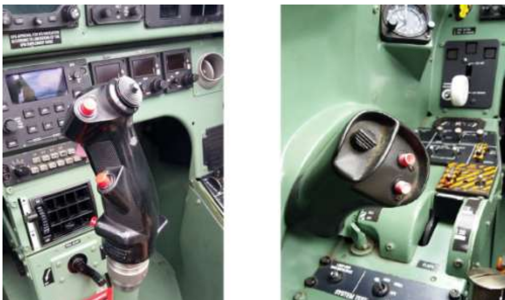
Slika7. Upravljačka palica i ručica snage HOTAS tipa
