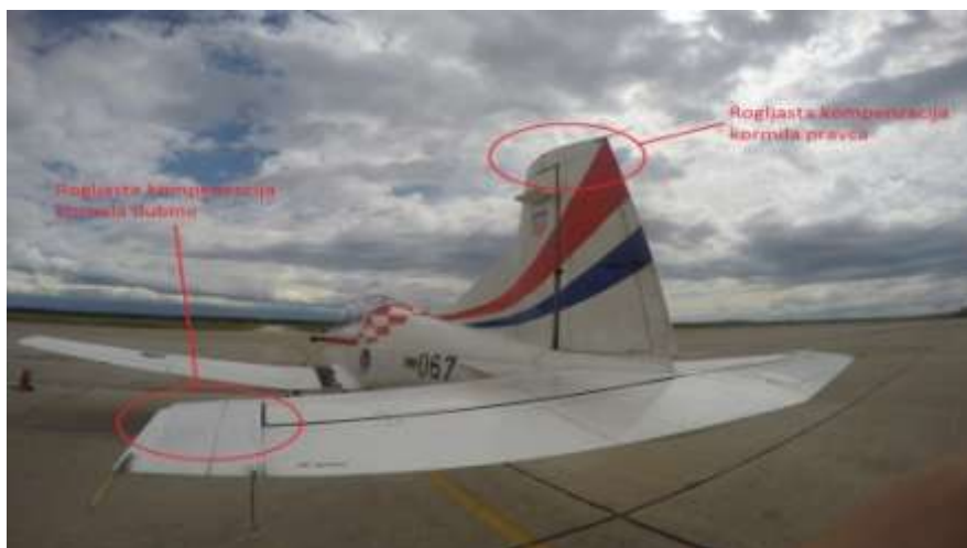
Slika 5. Aerodinamička rješenja poboljšanja upravljivosti na kormilu dubine i pravca
