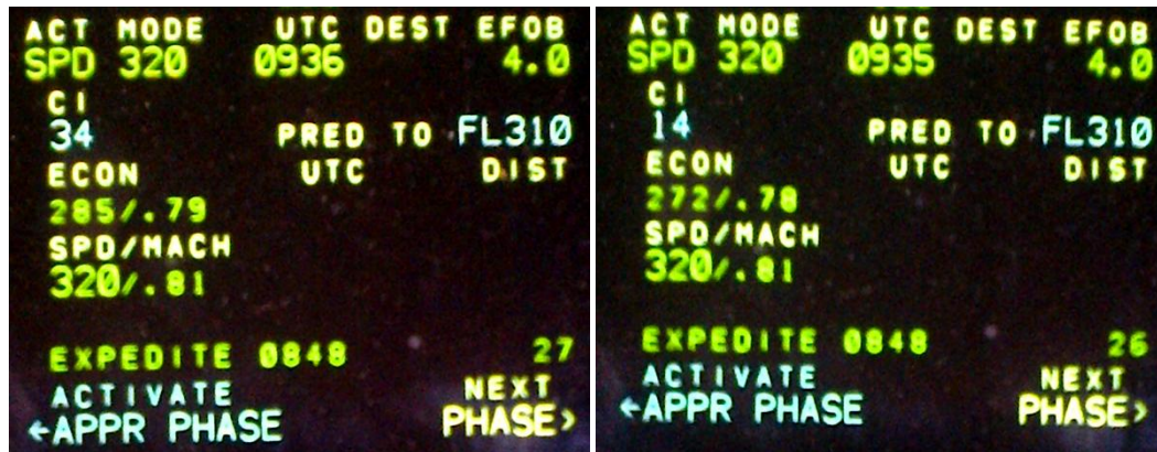
Slika 8: Prikaz brzine zrakoplova na upravljačkoj jedinici FMS sustava za vrijednost indeksa troškova: a) CI = 34 i b) CI = 14
