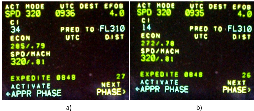
Slika 8: Prikaz brzine zrakoplova na upravljačkoj jedinici FMS sustava za vrijednost indeksa troškova: a) CI = 34 i b) CI = 14
