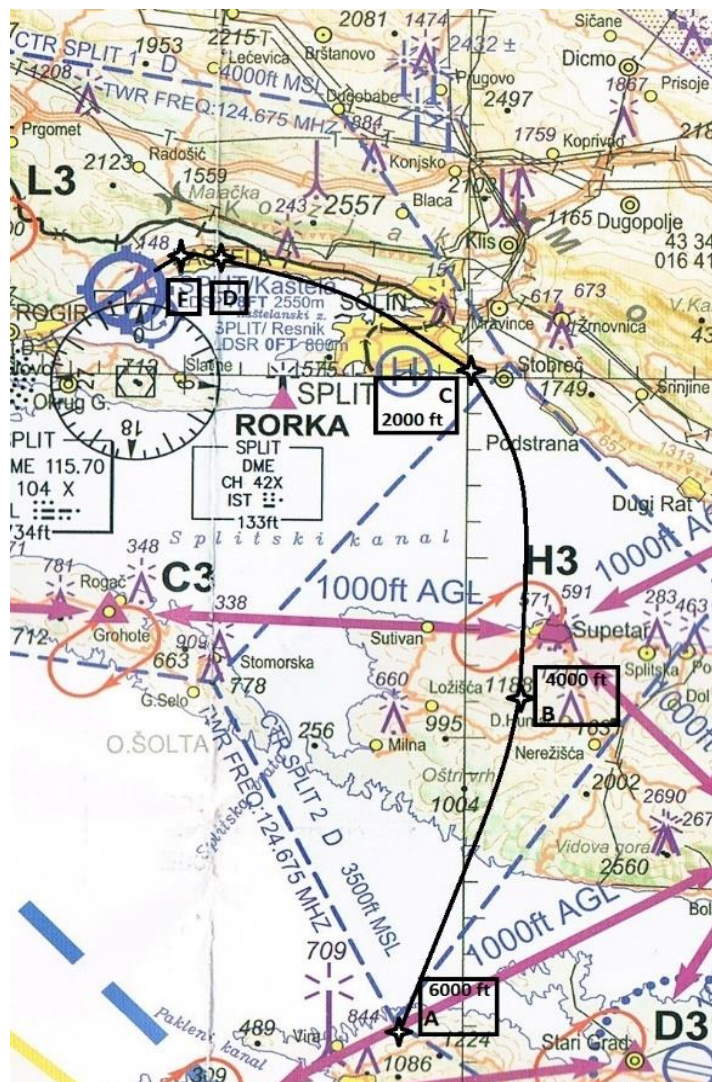
Slika 10. Prikaz moguće izvedbe zakrivljenog prilaza za stazu 23
