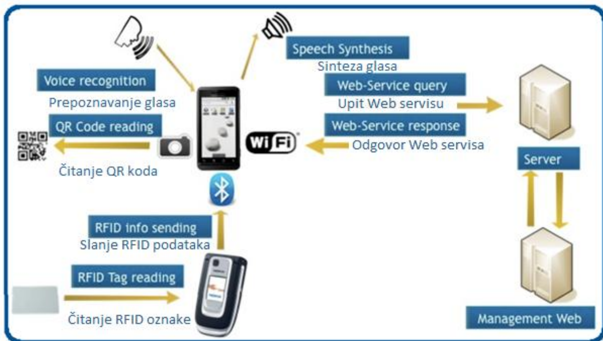
Slika 14. Prikaz arhitekture sustava za pomoć slijepima pri kupovini
