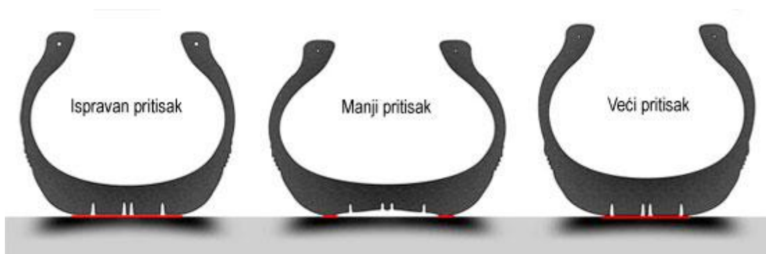
Slika 16. Nepravilno trošenje pneumatika, [14]
