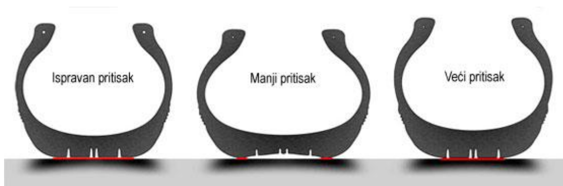
Slika 16. Nepravilno trošenje pneumatika, [14]
