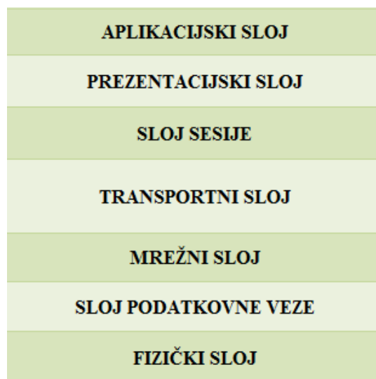
Slika 4. Prikaz OSI referentnog modela
