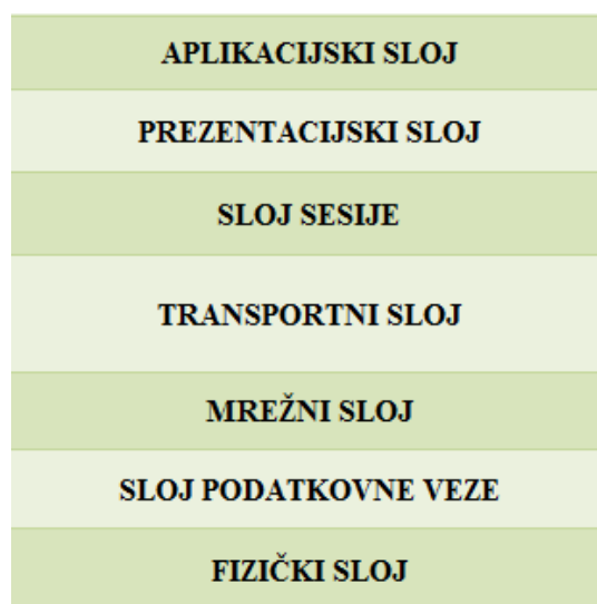
Slika 4. Prikaz OSI referentnog modela
