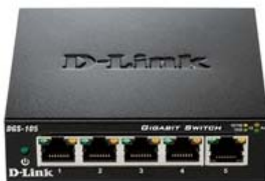
Slika 5. 5-portni 10/100/1000 Mbps switch uređaj
