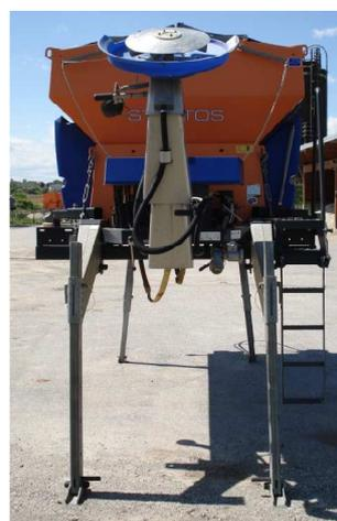
**Slika 6.4.2.** Silosni posipač
