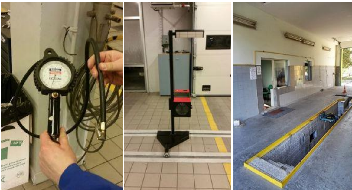
Slika 2. Prikaz kompresora s manometrom, regloskopa te kanala za pregled donjeg postroja vozila
