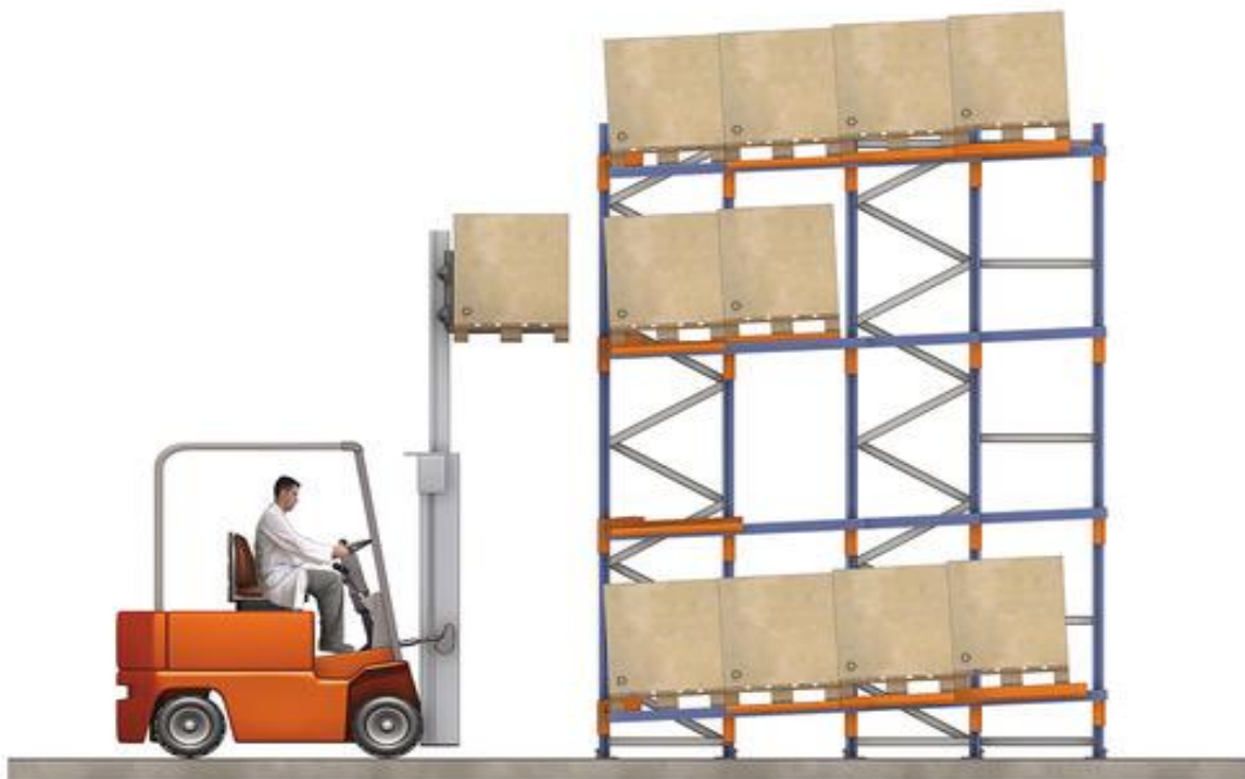
Slika 9. „Push back“ sistem skladištenja paleta
