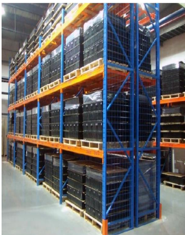
Slika 7. Jednostruki regali za palete Izvor: http://www.jracking.com/product_6_Selective_pallet_racking_system.html , srpanj 2015.
