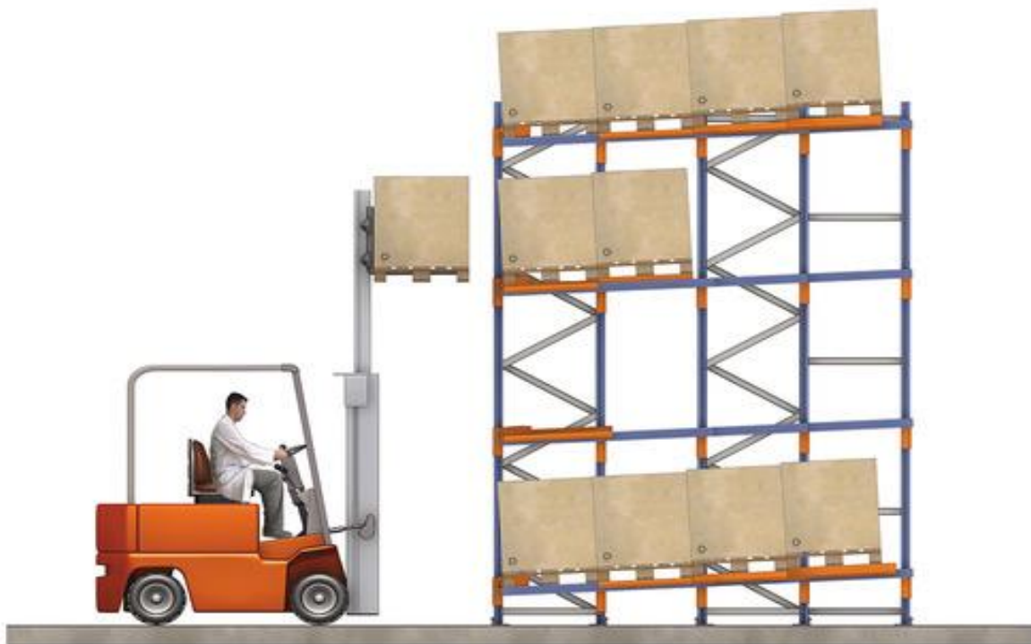
Slika 9. „Push back“ sistem skladištenja paleta
