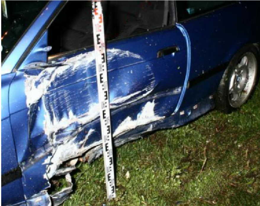
Slika 19. Nepravilno mjerenje deformacija na vozilu gdje je mjerna letva tek prislonjena na deformaciju na vozilu
