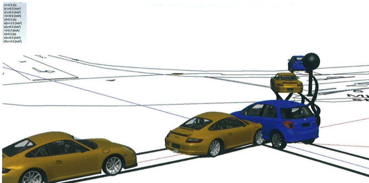
Slika 23. Računalna simulacija realnih sudarnih procesa na osnovi tragova na mjestu događaja primjenom računalnog programa PC Crash. [9]
