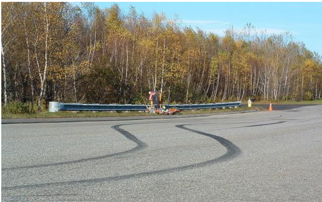
Slika 4. Tragovi zanošenja vozila na kolniku [15]
