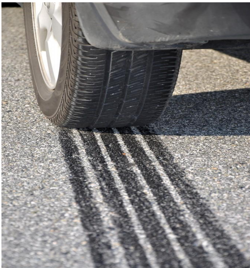
Slika 2. Trag kočenja neblokiranih kotača vozila [16]
