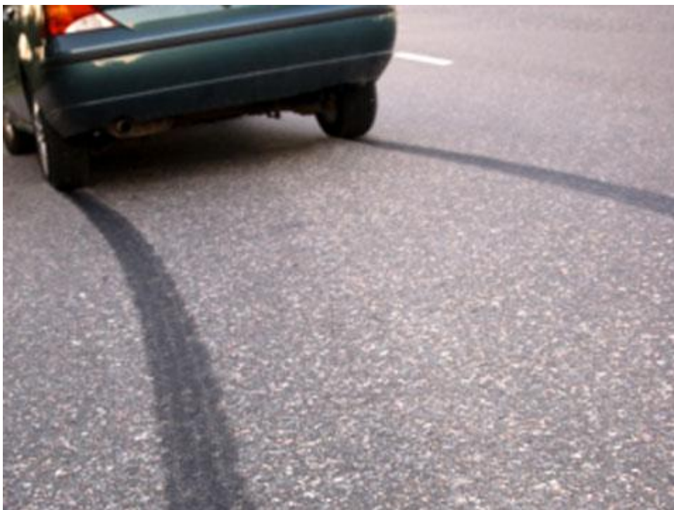
Slika 3. Tragovi kočenja s blokiranim kotačima [14]
