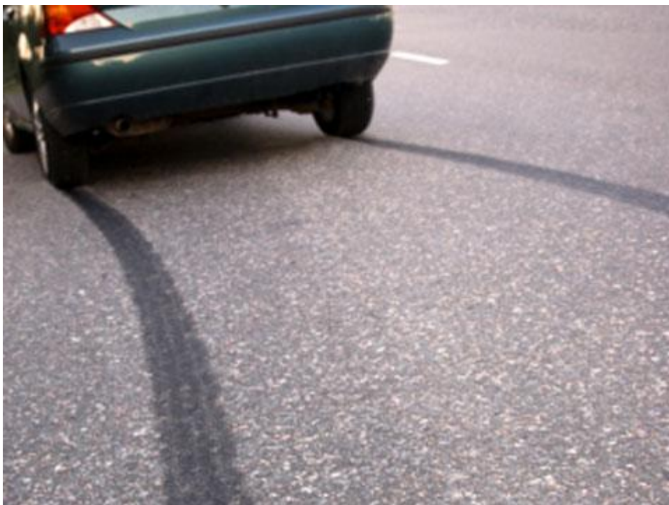
Slika 3. Tragovi kočenja s blokiranim kotačima [14]
