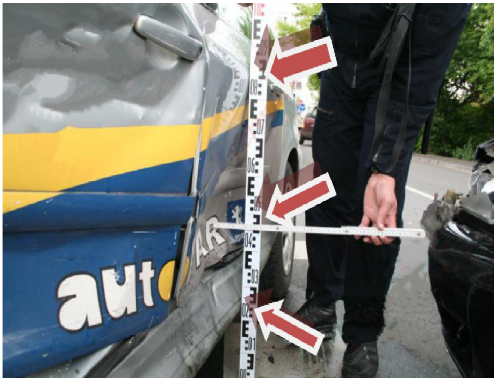
Slika 18. Mjerenje deformacije na vozilu gdje je mjerna letva prislonjena na neoštećeni dio vozila, a dubina izmjerena postavljanjem metra okomito na mjernu letvu i deformaciju na vozilu.
