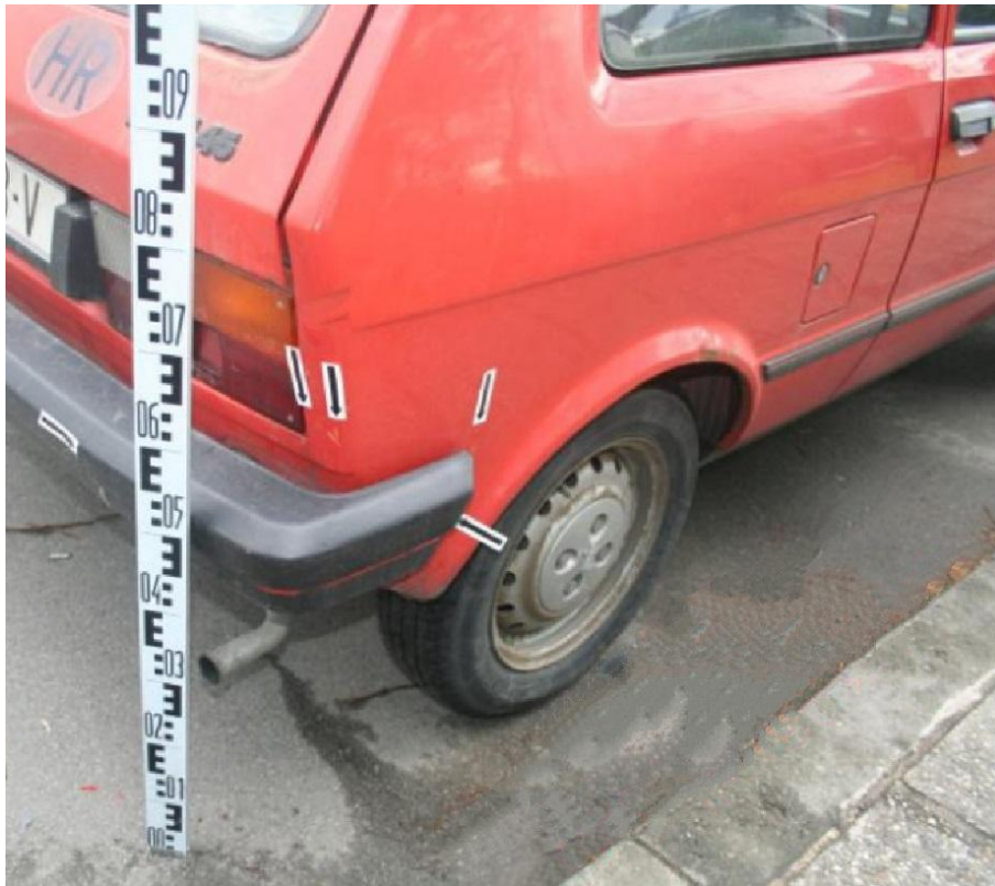
Slika 16. Mjerenje oštećenja na vozilu gdje su oštećenja označena, ali oštećenja nisu fotografirana pod pravim kutom, pa nije moguće točno očitati visine oštećenja.
