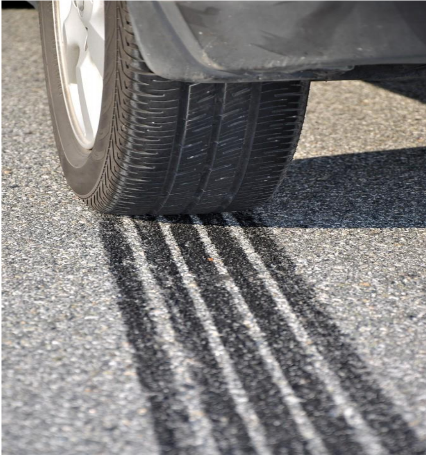
Slika 2. Trag kočenja neblokiranih kotača vozila [16]
