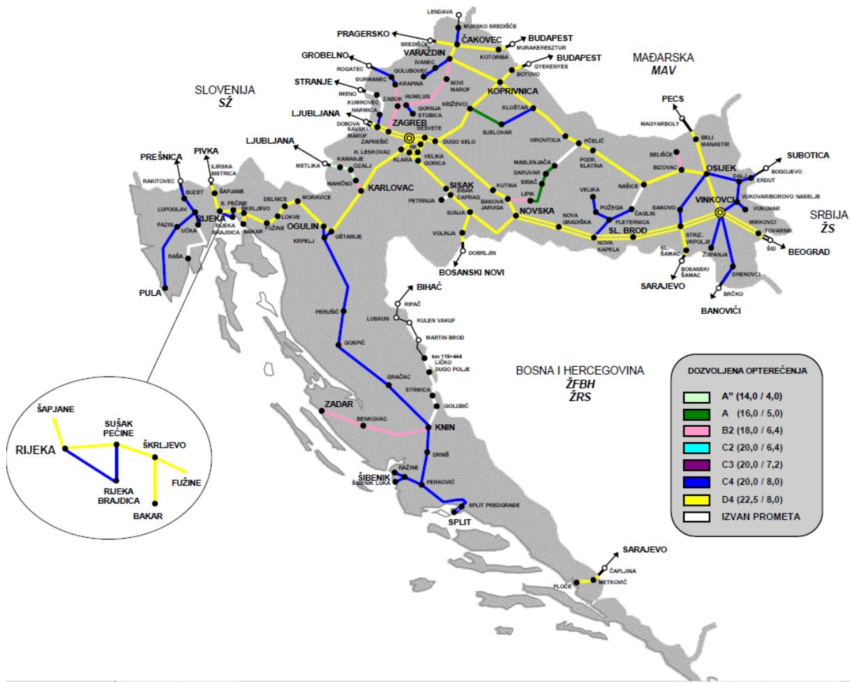
Slika 4. Pregled dozvoljenih opterećenja izraženih u tonama po osovini i tonama po duljinskom metru
