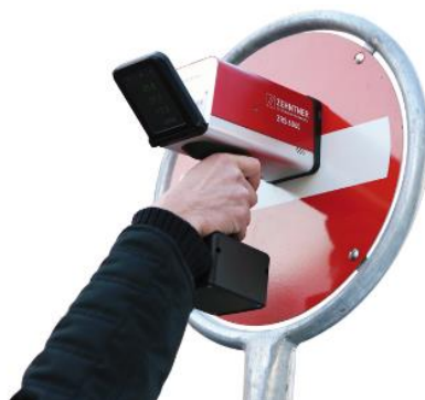
Slika 22. Princip ispitivanja retrorefleksije prometnih znakova ZRS 6060. retroreflektorom
