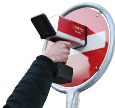
Slika 22. Princip ispitivanja retrorefleksije prometnih znakova ZRS 6060. retroreflektorom
