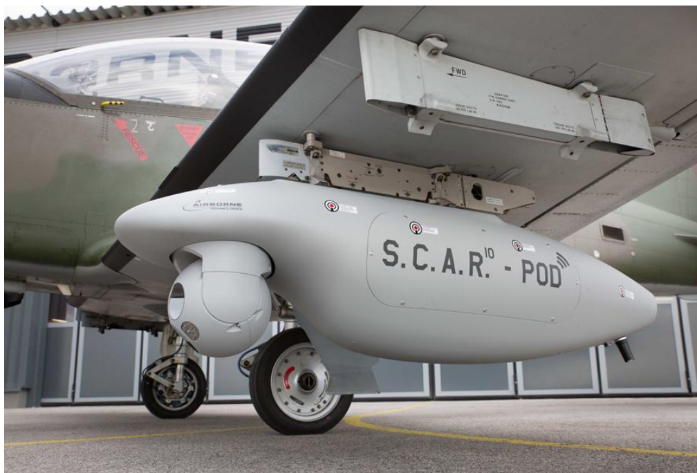
Slika 40. S.C.A.R. - POD montiran na Pilatus PC-9M slovenske vojske [25]
