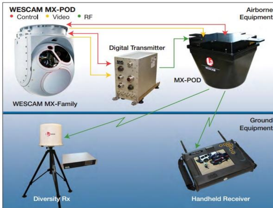
Slika 49. Prikaz spajanja MX-POD-a [28]
