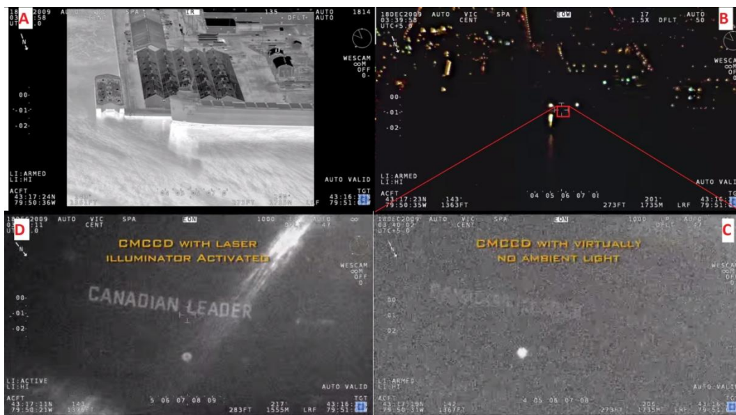
Slika 47. Prikaz mogućnosti laserskog osvjetlivača
