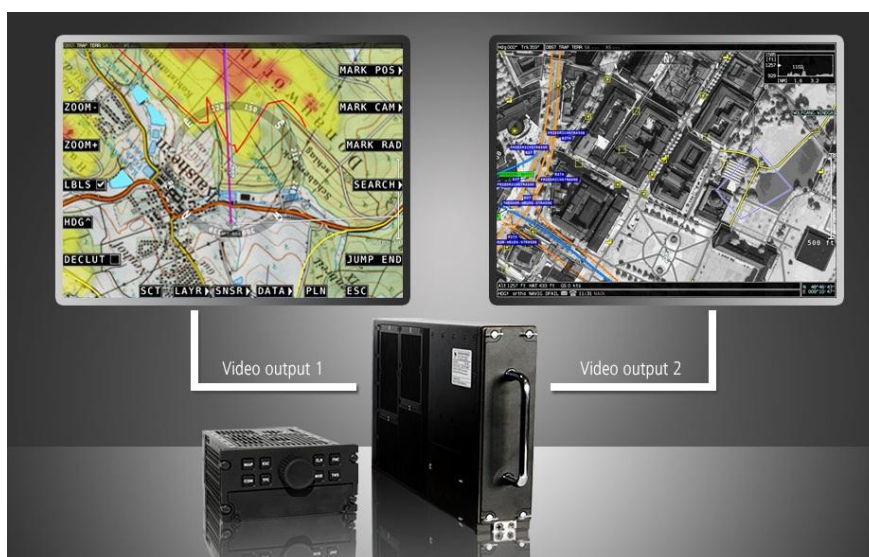
Slika 63. Prikaz dvostrukog video izlaza [35]
