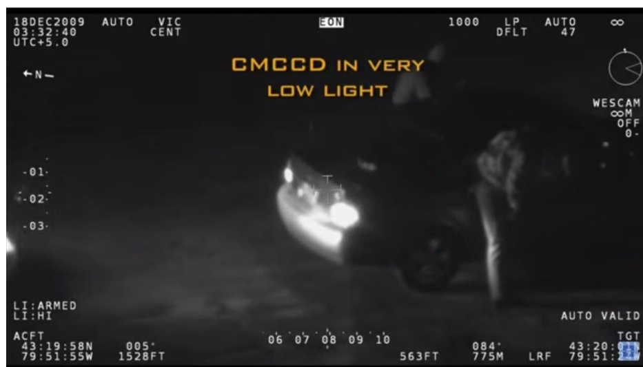
Slika 46. Snimanje pri slabom osvjetljenju sa CMCCD senzorom
