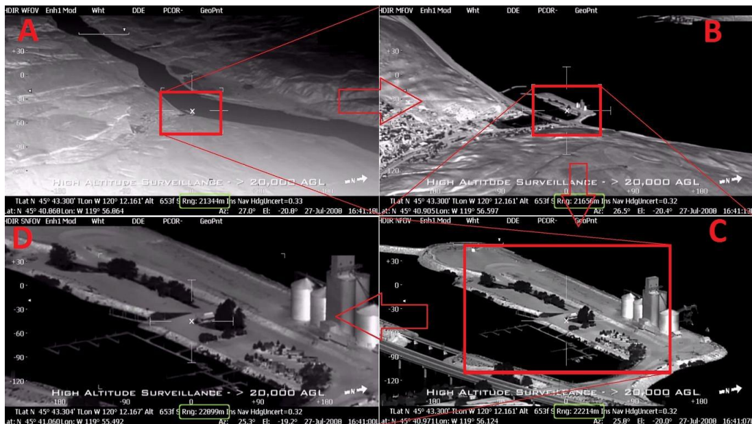
Slika 54. Prikaz mogućnosti uvećanja Star SAFIRE HD
