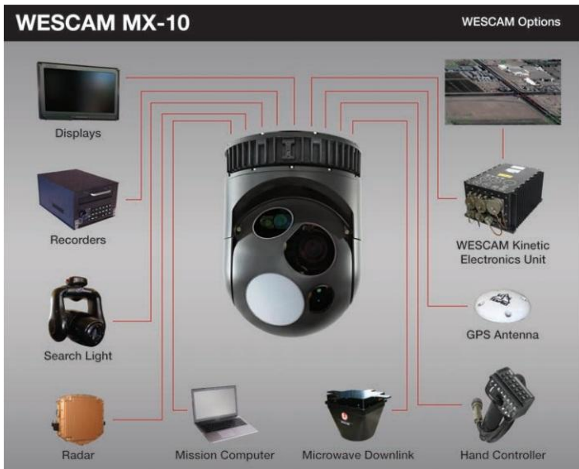
Slika 32. Način spajanja MX-10 [21]
