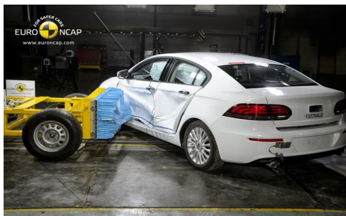
Slika 26. Crash test – testiranje vozila pri bočnom udaru [34]
