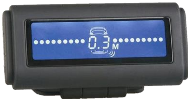
Slika 31. Jedan od brojnih načina prikaza udaljenosti pri parkiranju [39]
