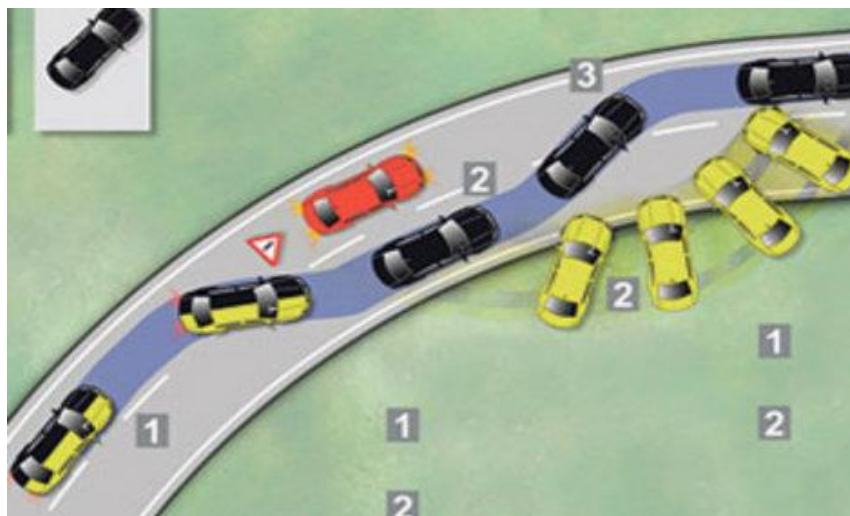
Slika 14. Crno vozilo ima ESP, a žuto nema [25]
