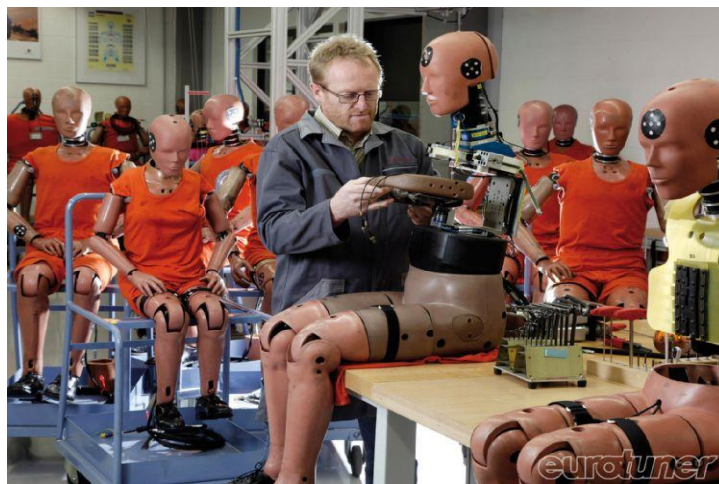
Slika 24. Priprema Crash test lutke [33]
