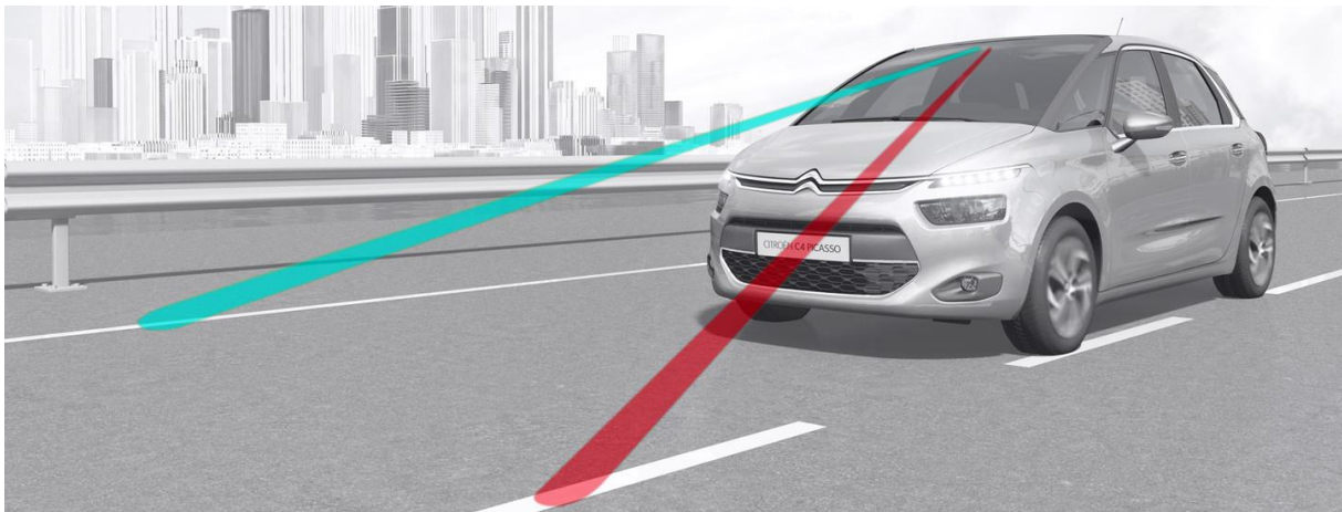
Slika 40. Sustav za upozorenje o nenamjernom prelazanju crte uz pomoć kamere [45]
