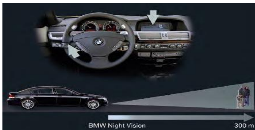
Slika 55. Položaj prekidača za uključivanje uređaja za poboljšanje vidljivosti i smještaj ekrana [13]
