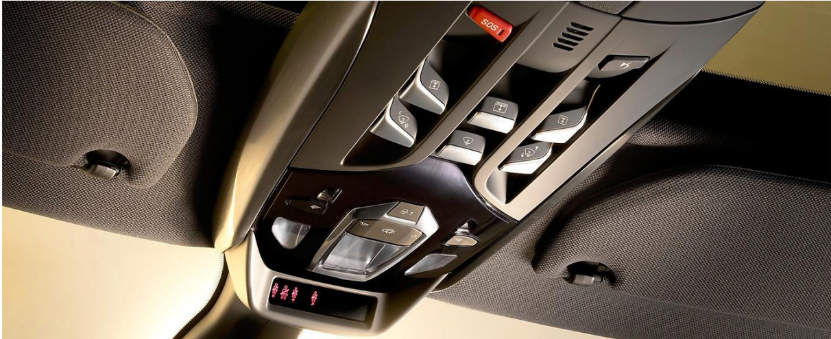
Slika 38. Smještaj tipke za poziv u nuždi [44]
