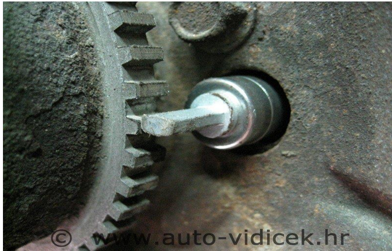
Slika 6. Senzor i zupčanik ABS-a [18]
