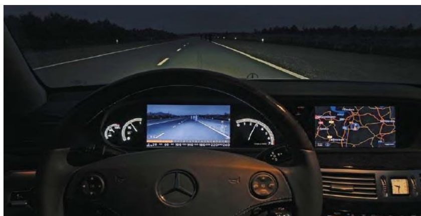
Slika 56. Poboljšanje vidljivosti i smještaj ekrana u Mercedesu [13]
