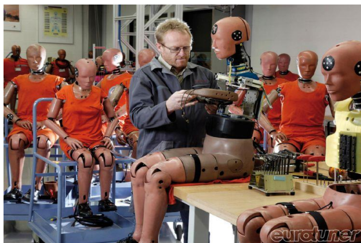
Slika 24. Priprema Crash test lutke [33]
