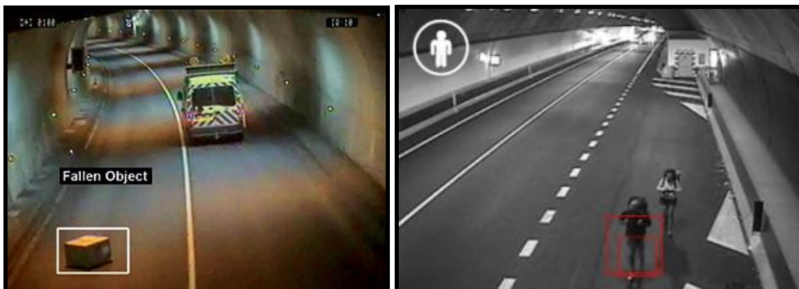
Slika 31. Video detekcija rasutog tereta i pješaka, izvor [30]
