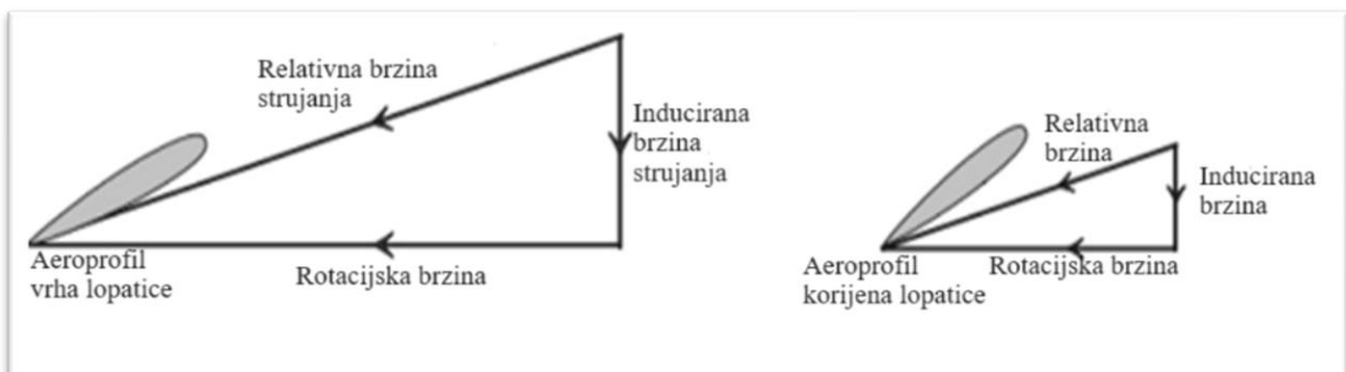
Slika 4. Prikaz relativne brzine duž lopatice rotora
