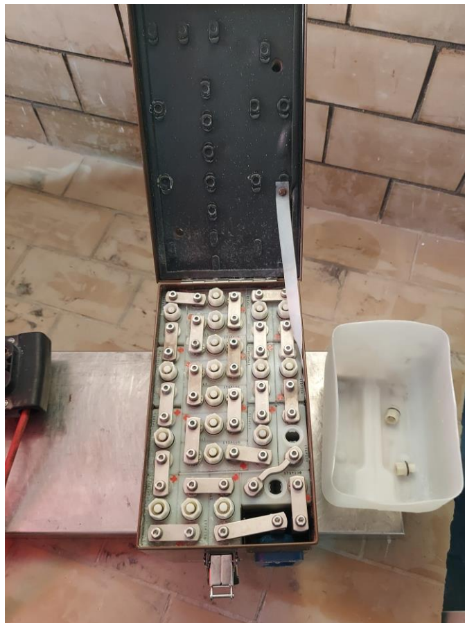
Slika 3. Kućište akumulatora s ćelijama
