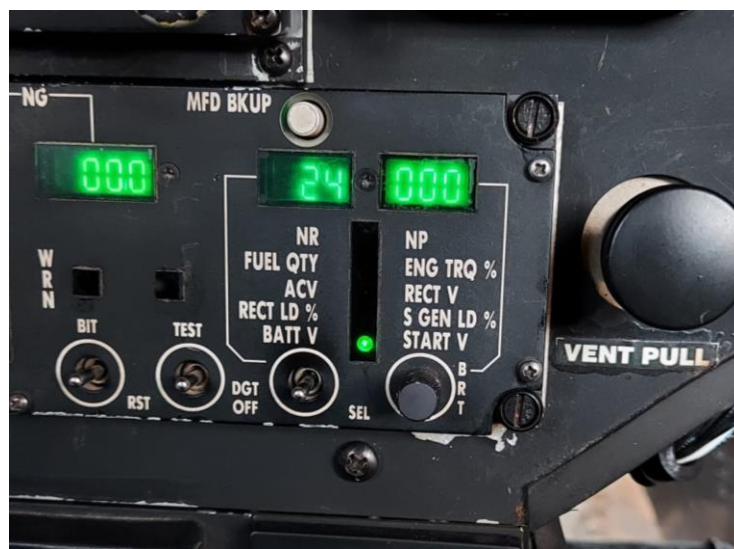
Slika 24. Prikaz napona akumulatora u pilotskoj kabini
