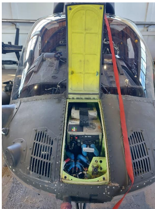
Slika 8. Bliži prikaz položaja akumulatora na helikopteru Kiowa Warrior
