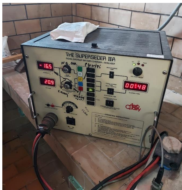
Slika 16. Pražnjenje akumulatora nakon 48 minuta
