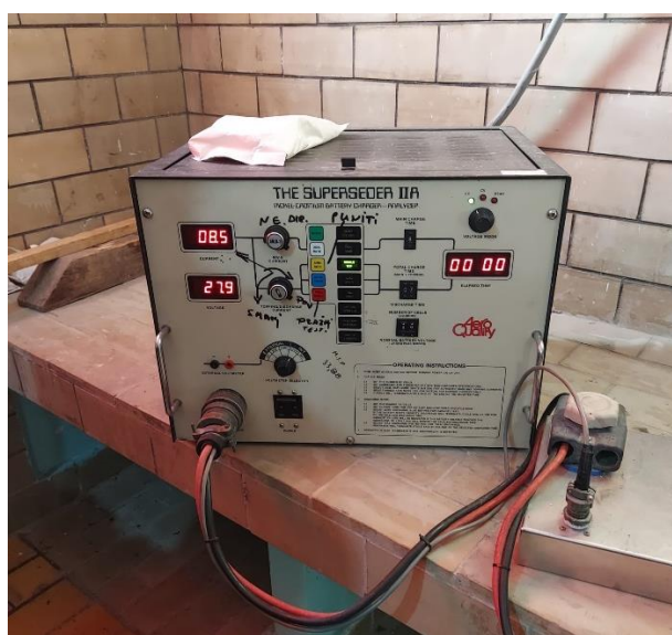
Slika 13. Uređaj za testiranje nikal-kadmijevih akumulatora
