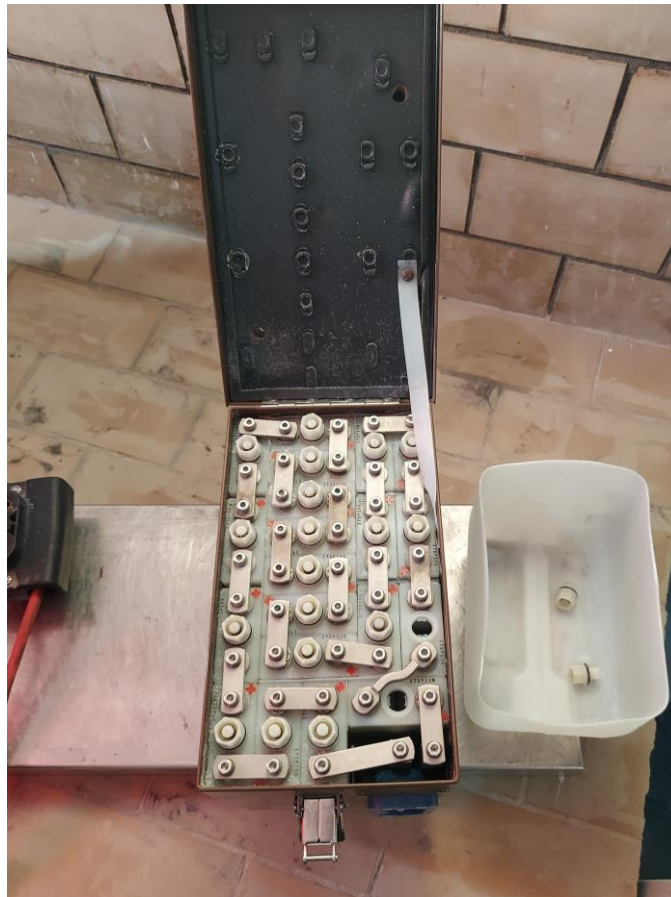
Slika 3. Kućište akumulatora s ćelijama
