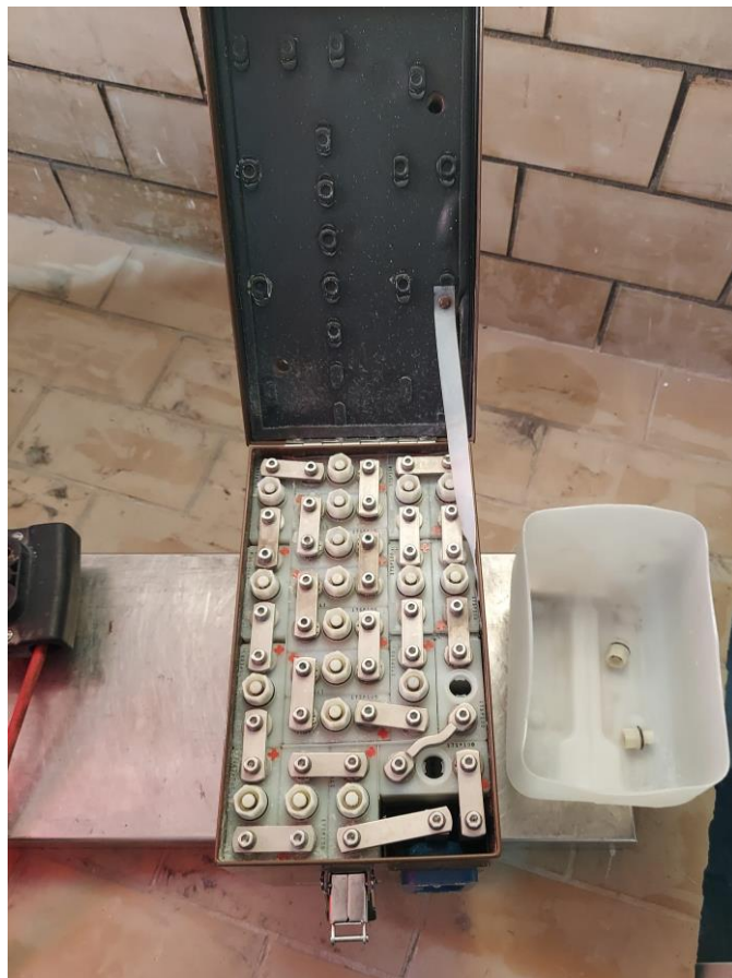
Slika 3. Kućište akumulatora s ćelijama
