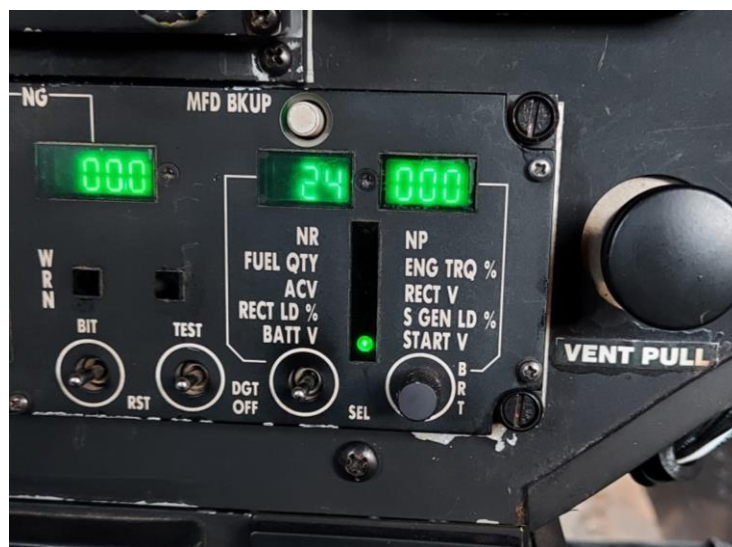
Slika 24. Prikaz napona akumulatora u pilotskoj kabini
