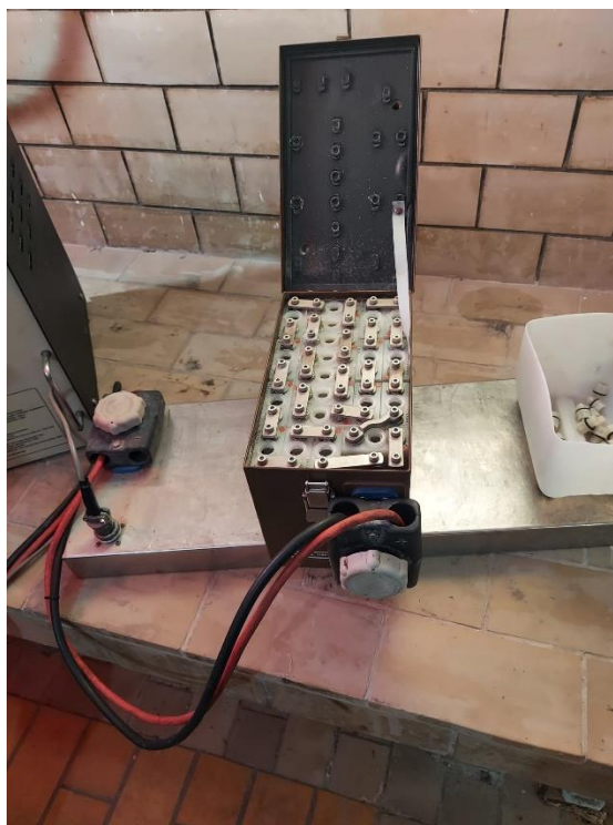
Slika 12. Prikaz ćelija bez pripadajućih čepova
