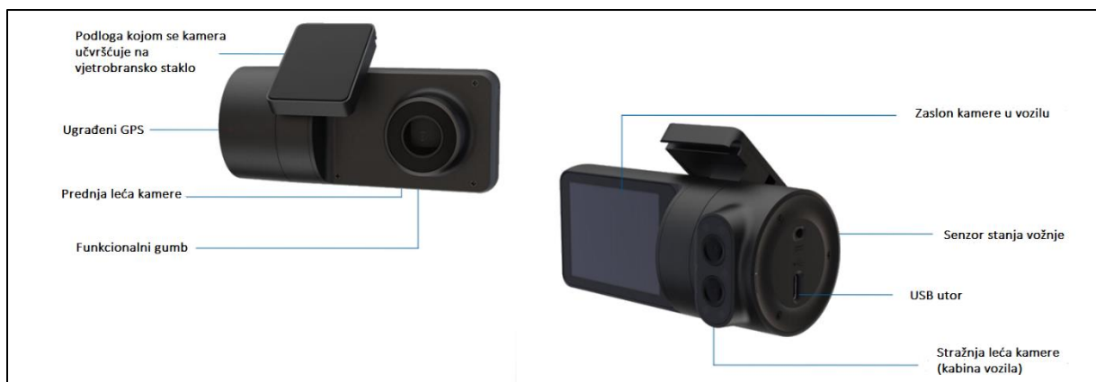
Slika 8. Dijelovi kamere za praćenje dinamike kretanja vozila Izvor: https://gpstechnologies.com/dashcams/
