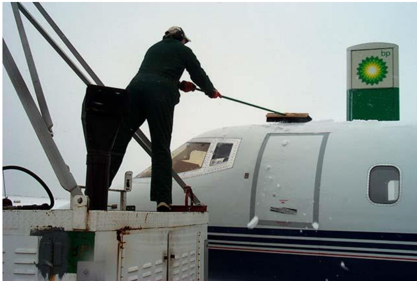
Slika 16. Uklanjanje kontaminanata mehaničkom metodom – upotrebom metle Izvor: [20]
