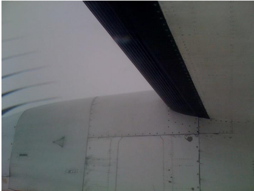
Slika 17. Pneumatski „de-ice boots“ sustav (crne boje) za uklanjanje leda na krilima Izvor: [21]
