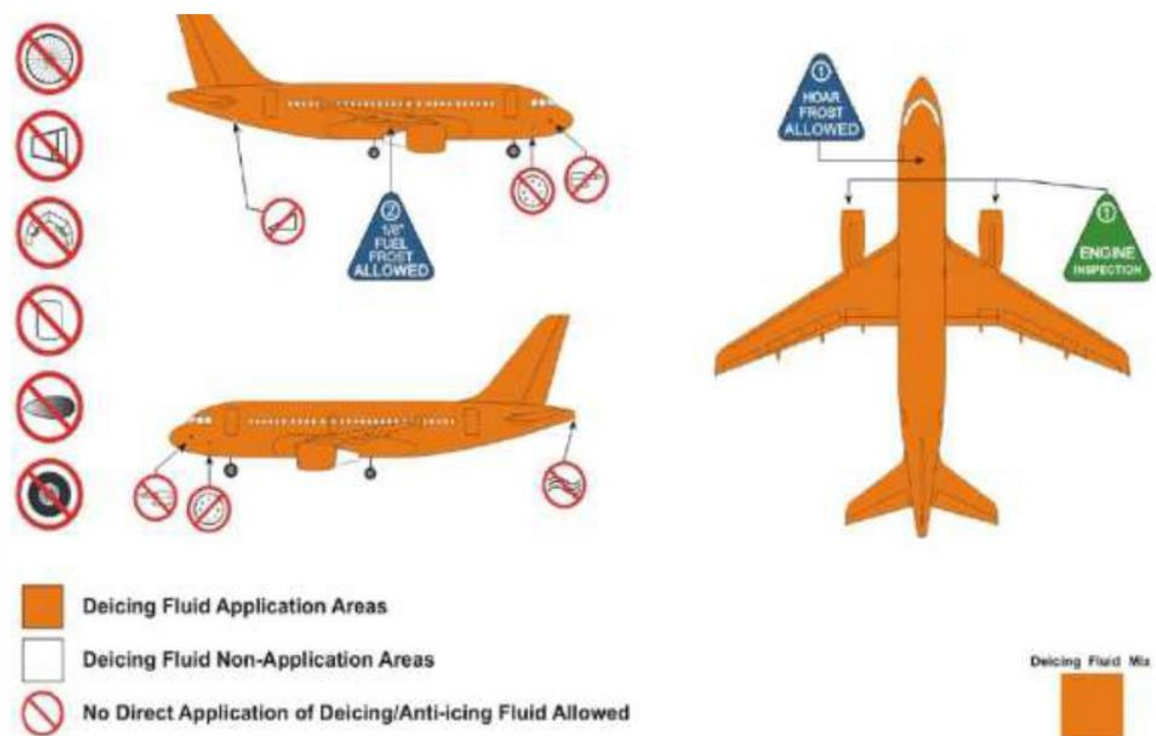
Slika 14. Dijagram dopuštene primjene fluida za odleđivanje - A318/319 Izvor: [10]
