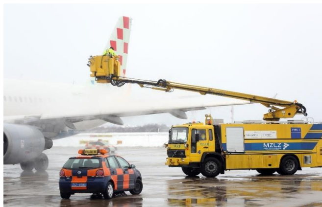
Slika 6. Vozilo za provođenja procesa odleđivanja zrakoplova tekućinom tip I Izvor: [12]
