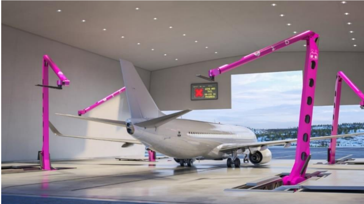
Slika 23. Robot spreman za pranje, održavanje i provođenje tehničkih inspekcija Izvor: [26]
