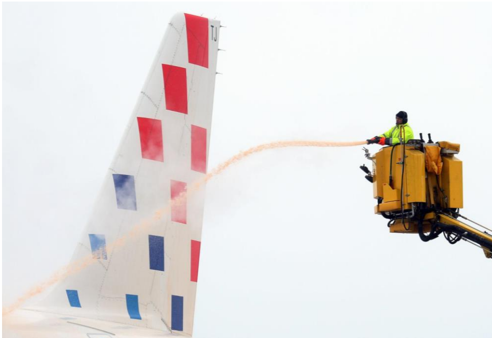
Slika 9. Mlaznice za prskanje tekućine za odleđivanje / zaštitu od zaleđivanja Izvor: [13]
