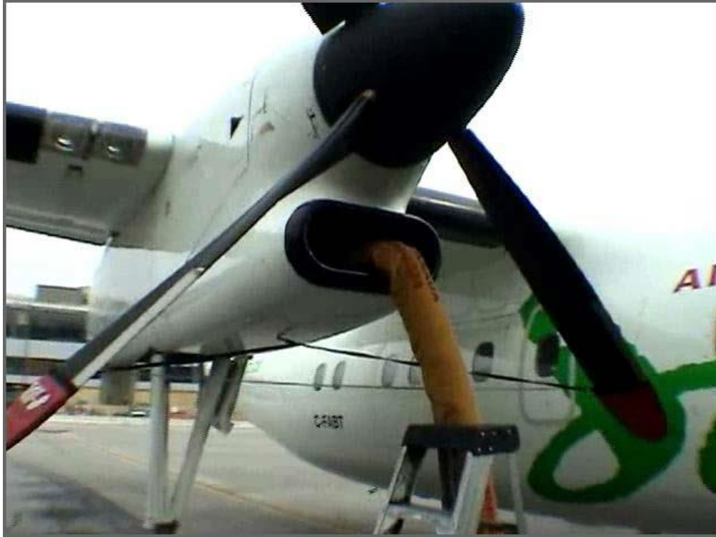
Slika 18. Odleđivanje zrakoplova primjenom vrućeg zraka Izvor: [20]
