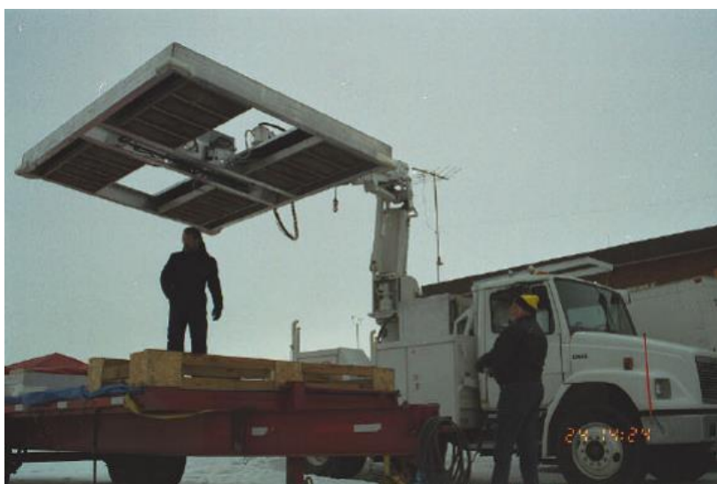
Slika 20. Mobilni infracrveni sustav - ICE CAT Izvor: [23]
