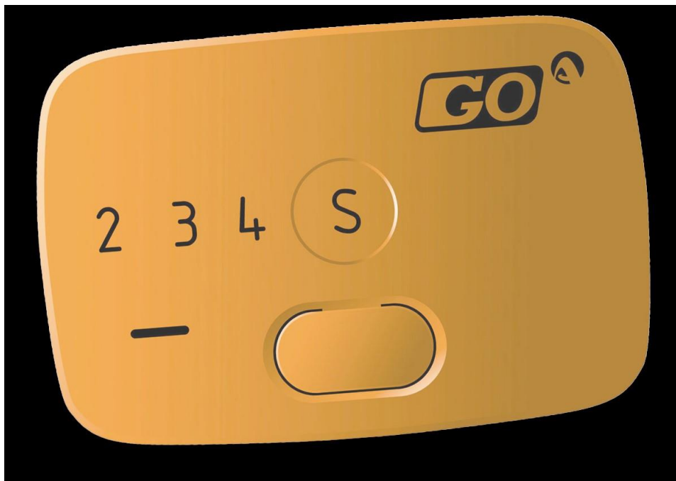
Slika 5. GO-BOX, elektronički sustav za neizravnu naplatu cestarine
