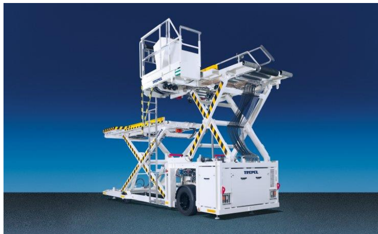
Slika 7. Utovarivač za utovar i istovar robe iz zrakoplova
