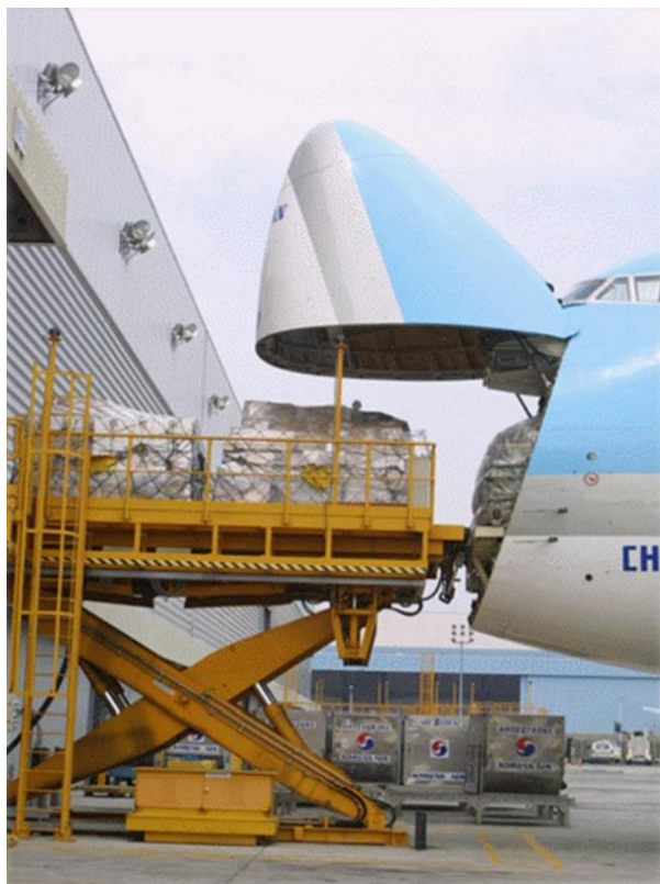
Slika 19. Ukrcaj robe u zrakoplov preko nosnih vrata, [16]
